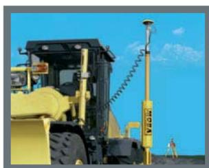
directamente para a máquina, a piquetagem no local, por exemplo com fios não é necessária. Os dados de medição são convertidos através de um programa de computador especial e de uma estação
